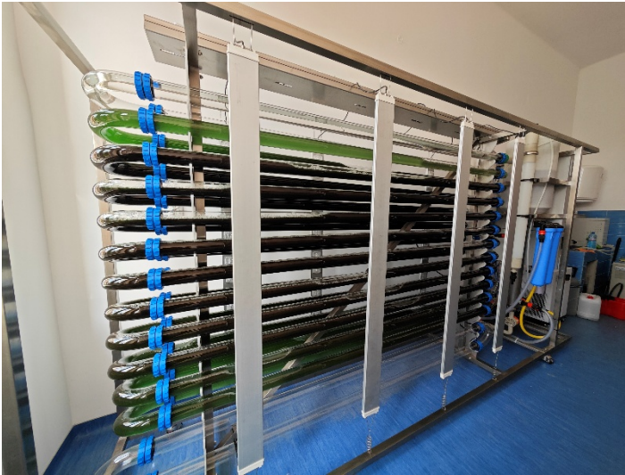
Фигура 3. Горизонтален тръбен фотобиореактор с общ обем 300 литра за култивиране на водорасли.
