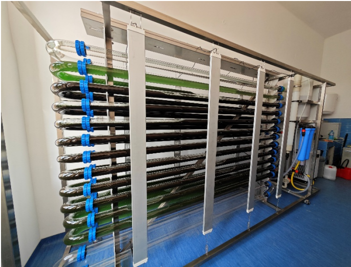
Фигура 3. Хоризонтален тръбен фотобиореактор с общ обем 300 литра за култивиране на водорасли.
